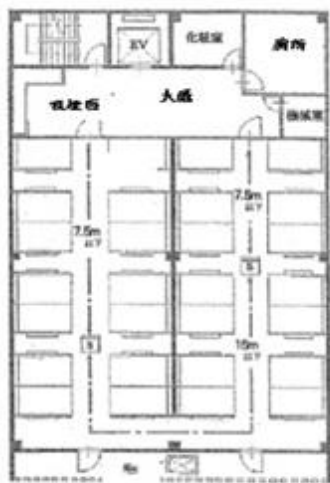
圖1 室內走道設置探測器例
