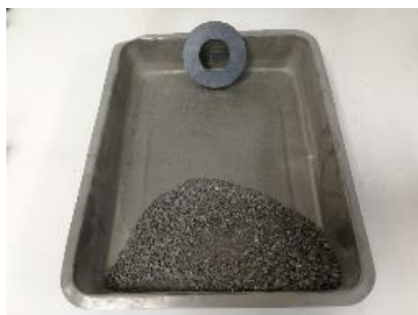
圖 4 磁吸試驗合格結果
