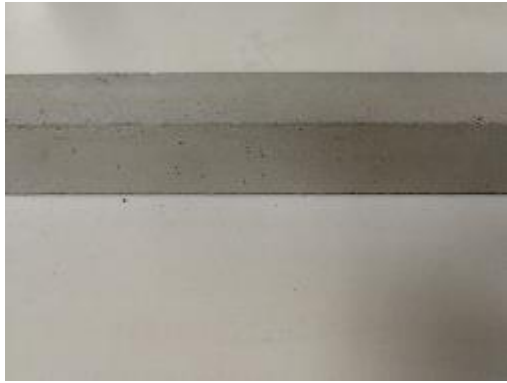
圖 6 熱壓膨脹試驗合格結果
