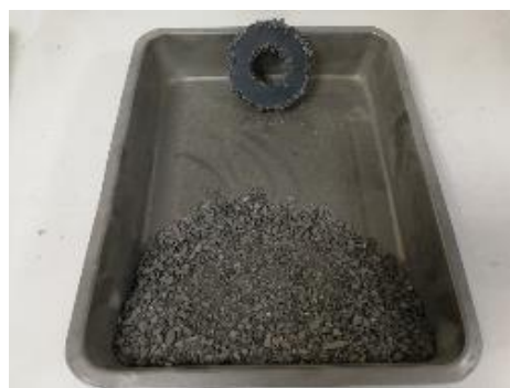
圖 5 磁吸試驗不合格結果
