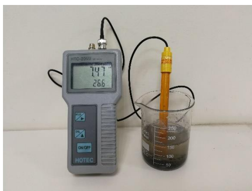
圖 2 鹼質試驗合格結果
