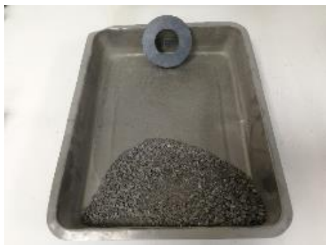
圖 4 磁吸試驗合格結果
