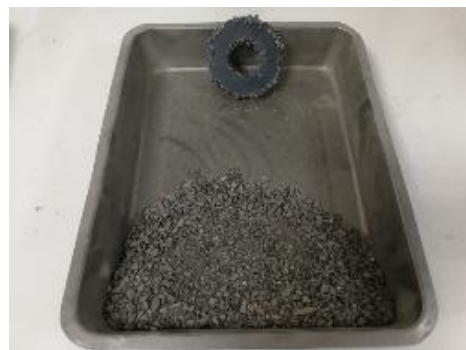
圖 5 磁吸試驗不合格結果
