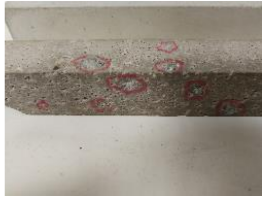
圖 7 熱壓膨脹不合格結果
