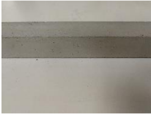
圖 6 熱壓膨脹試驗合格結果
