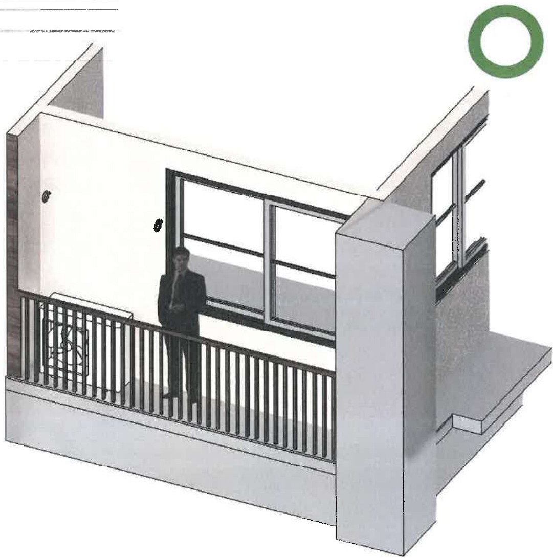
圖 2-2、露樑設置室外機範例
