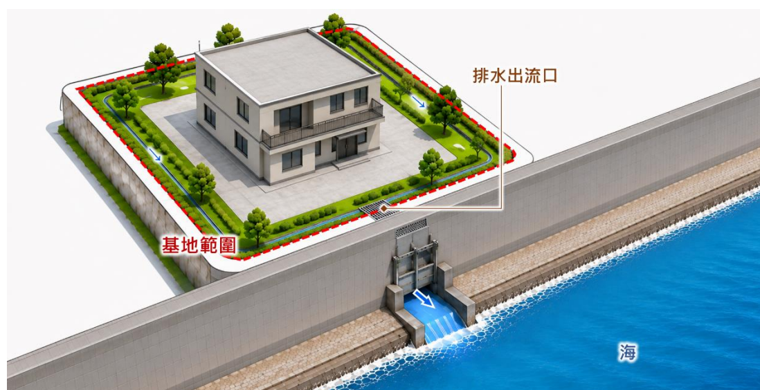
(a) 排水出口直接排入海洋
