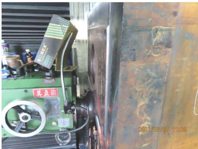
端板鐸接前端洗磨平
