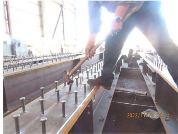
剪力釘 15 度敲擊查驗
