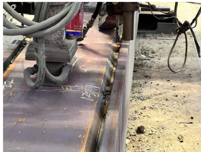
ESW 電熱熔渣銲接
