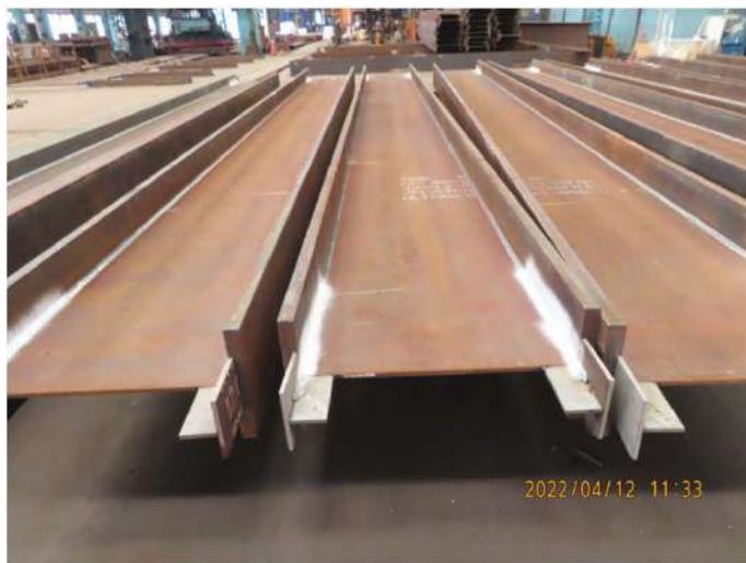
鋼梁 P T 檢驗
