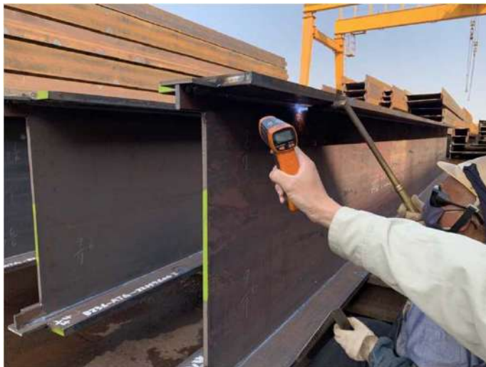
溫度計量測整形中溫度
