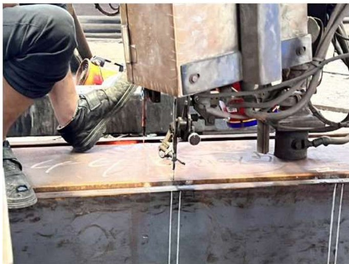
ESW 電熱熔渣銲接
