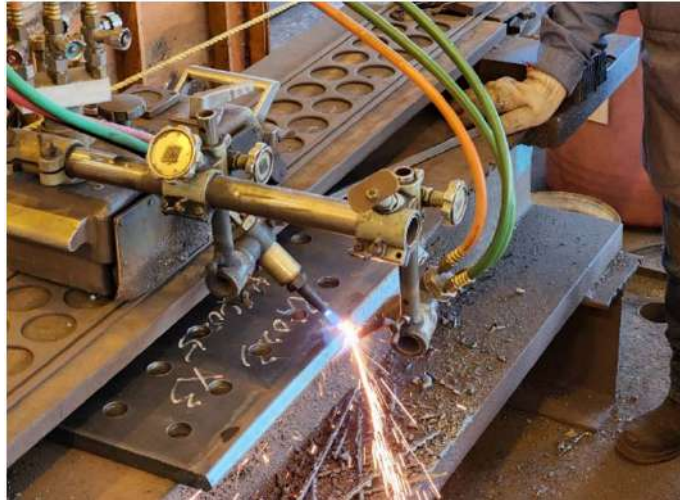
鋼板切割開槽
