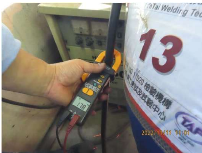
銲工考試銲中電流查驗
