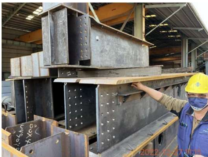
鋼梁穿筋孔徑尺寸量測
