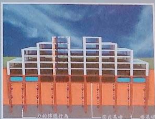
基樁直接深入較深的地盤中,較適用於大型建築物或地質軟弱的地區。
