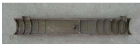
鋼筋續接器剖面
