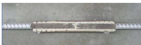
鋼筋續接器(灌漿)剖面
