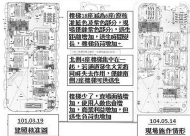
影城棟建照核准圖及現場施作情形對照
