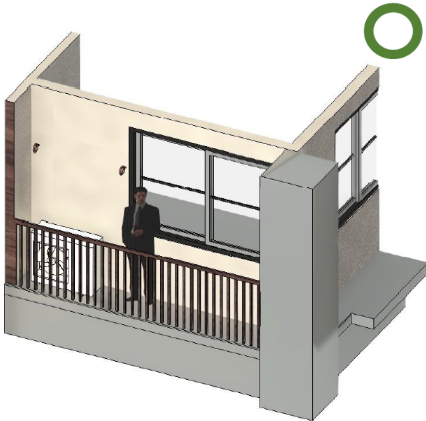
圖 2-2、露樑設置室外機範例
