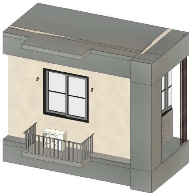
圖 2-1、雨遮設置室外機範例
