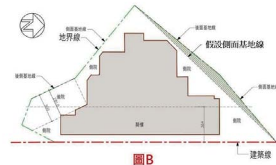
圖B 該部分土地計入申請建築基地面積，核算建蔽率及容積率時予以扣除
