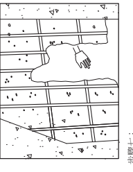
步驟七： 於黏著劑未硬化前，以修補材料填補已敲除之部位，並加以整平及養護。(鋼筋保護層厚度依施工規範第0310章「鋼筋」規定辦理。
