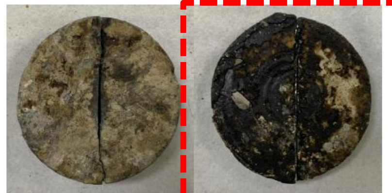
【圖 45】基礎 2 鑽心試體頂面(左)及底面(右)照片
