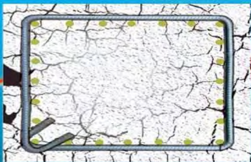
柱體開裂 保護層脫落
