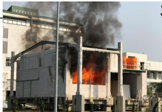
實尺寸構架屋火害實驗
