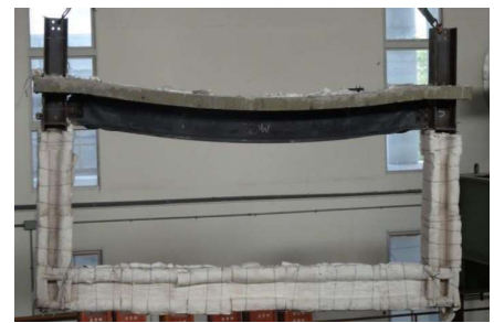
平面鋼構架梁耐火試驗
