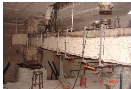
RC樑柱接頭耐火試驗
