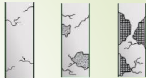
輕度破壞 中度破壞 嚴重破壞
