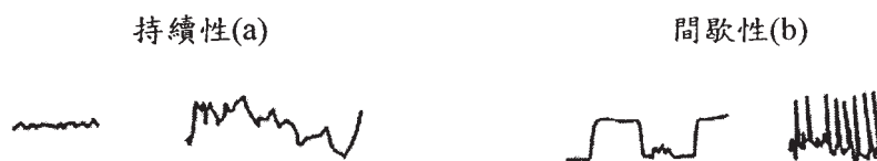
圖一 不同振動樣態說明圖
