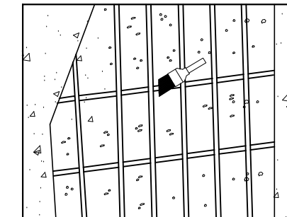
步驟五： 於清理後1小時內，鋼筋塗上防鏽劑，防鏽劑可採環氧鋅粉底漆。
