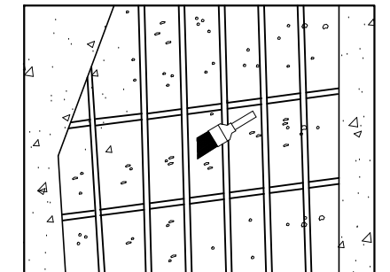
步驟六： 以高壓噴槍清除施工範圍之粉塵及鬆動碎屑，再於混凝土面塗上新舊混凝土接著劑，此接著劑與修補物質及混凝土具有相容特性，接著劑材料應先提具試驗證明文件並經工程司認可。
