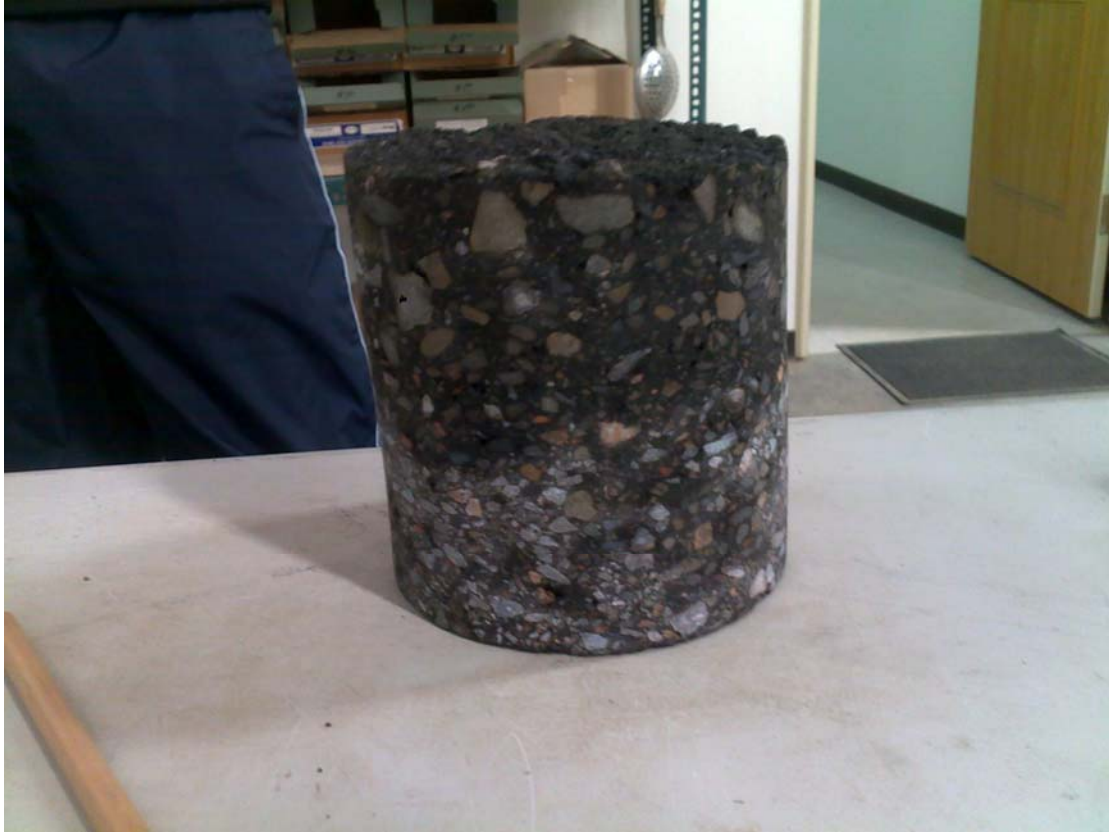
圖 3-3：非屬本次試驗之瀝青混合料、黏層及雜物等，均須清除乾淨。
