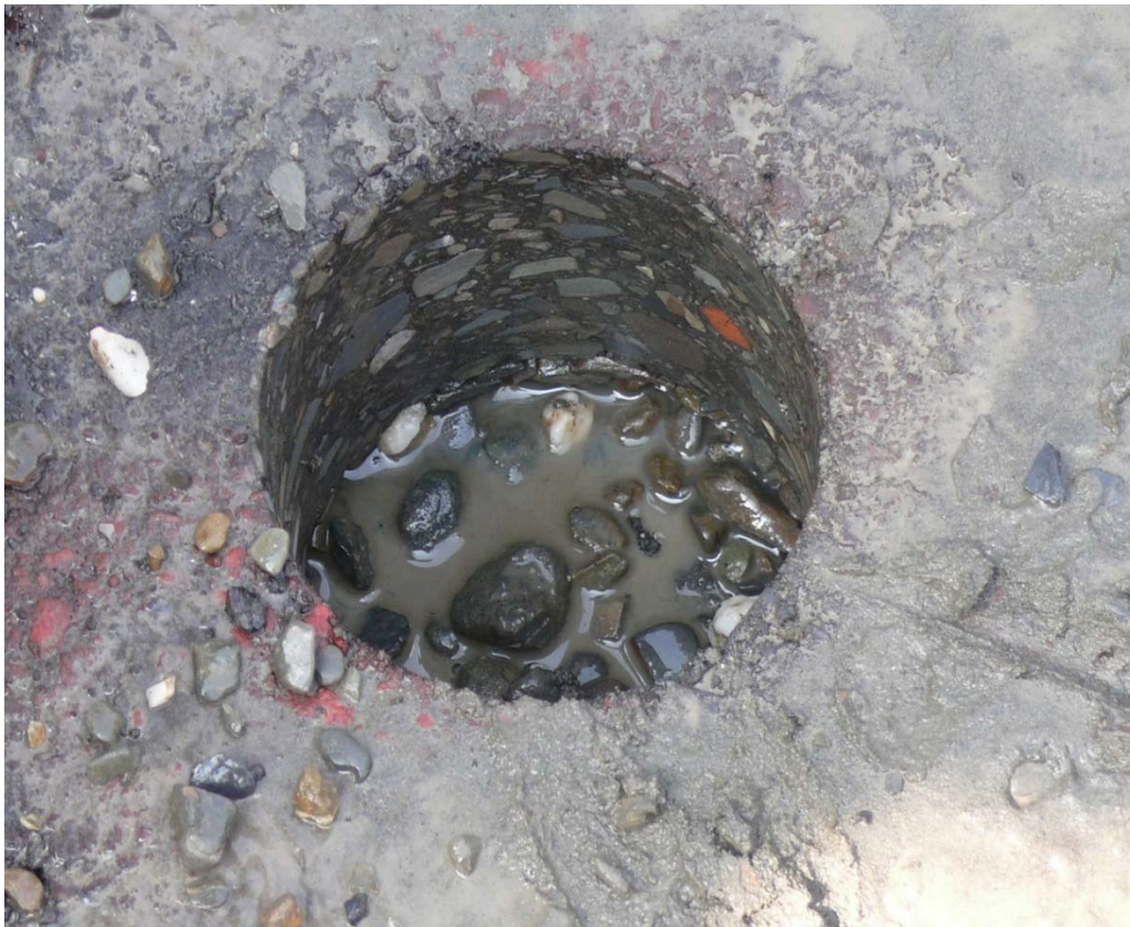
圖 3-2：取得樣品須為整個材料之全部深度。
