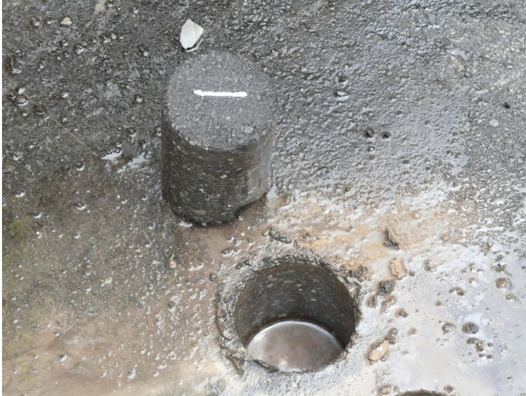
圖 3-1：以鑽掘方式取樣(直徑 20cm 以上之)。
