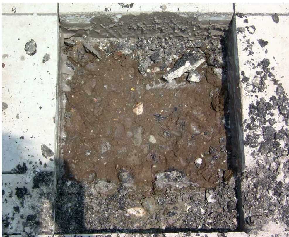
圖 2-2A：取得樣品須為整個材料之全部深度(取至級配層)。
