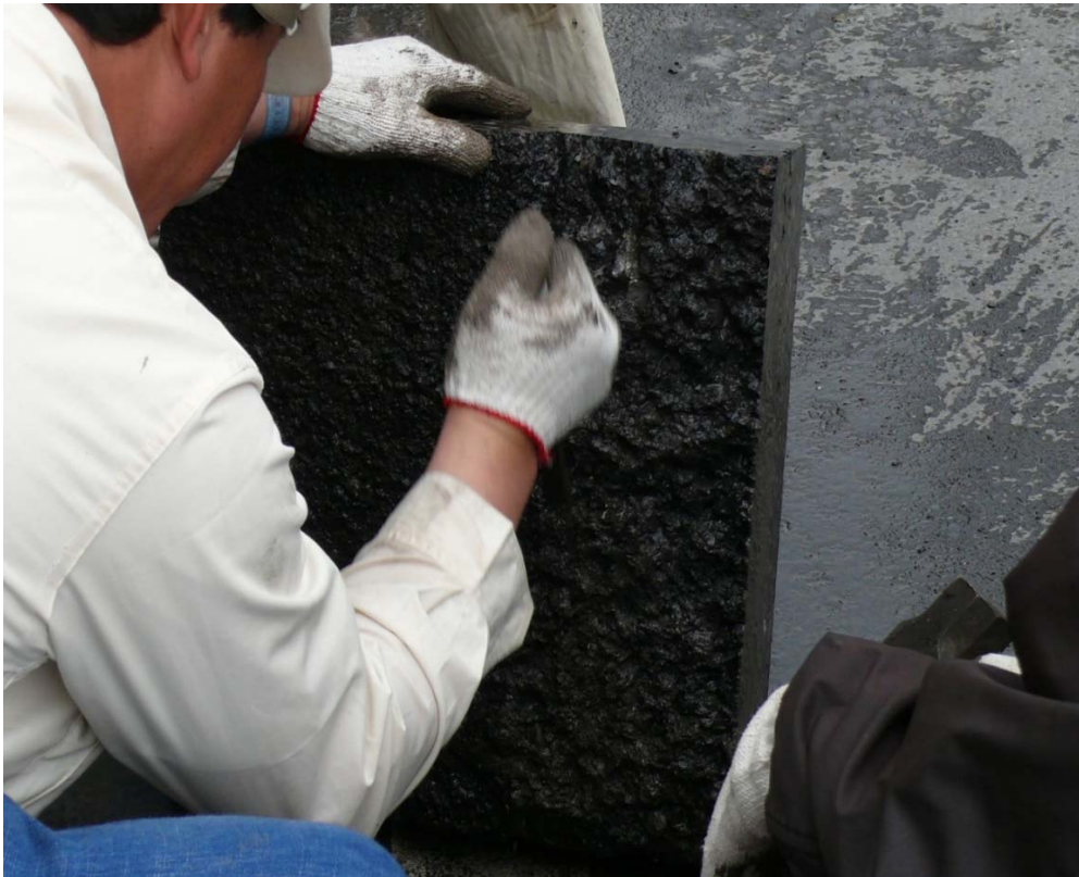
圖 2-3：非屬本次試驗之瀝青混合料、黏層及雜物等，均須清除乾淨。
