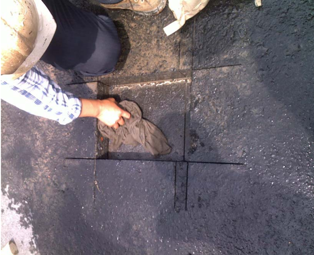
圖 2-2B：取得樣品須為整個材料之全部深度(取至底層)。
