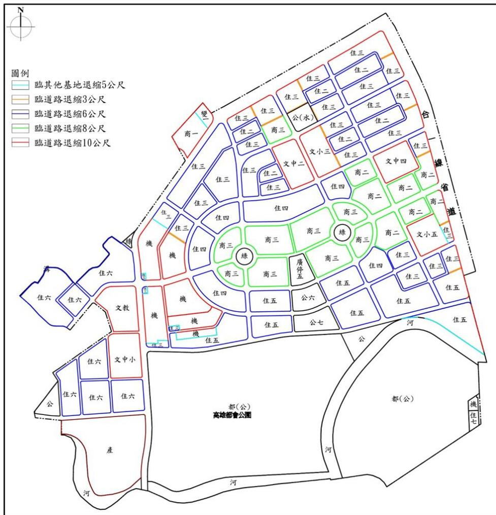
圖五 建築基地臨道路退縮示意圖
